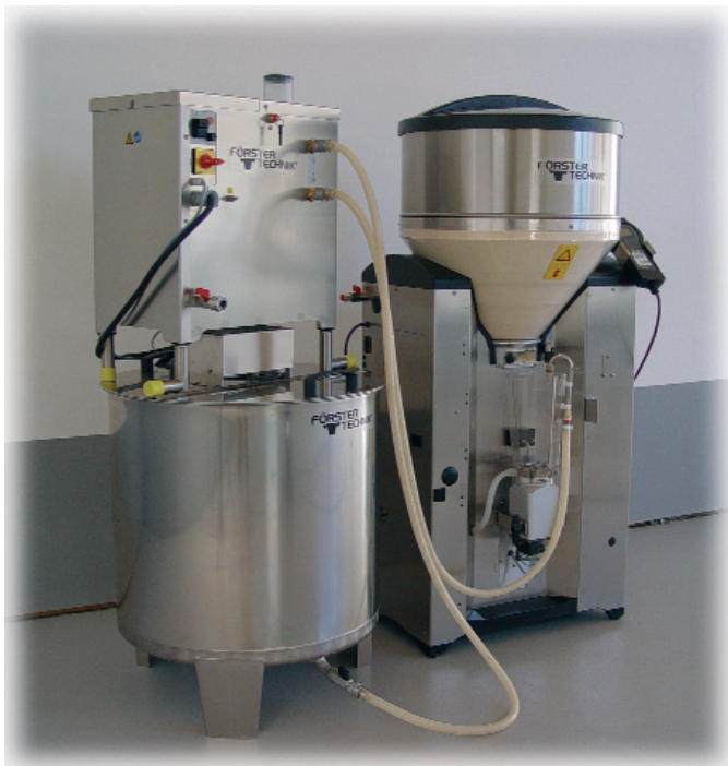
Beistell-Wärmetauscher und Milchtank (Zubehör) zu einer Einheit aufgebaut
