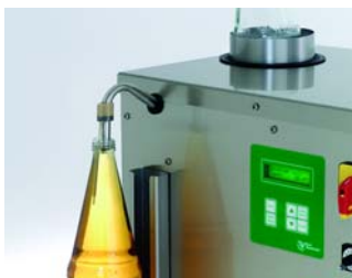
Flaschenabfüllung mit Füllstandsensor
