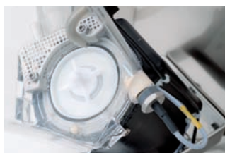
Senseur de température dans le gobelet mélangeur.
