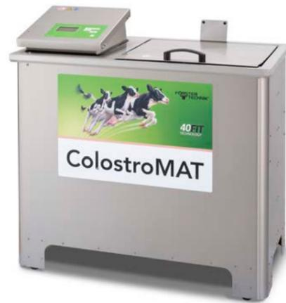
Mit dem **ColostroMAT**, dem Herzstück des Kolostrum-Managements von Förster-Technik werden ein oder zwei ColostroBAGs mit jeweils 3,8 l Kolostrum im Wasserbad für 60 Minuten bei 60 °C pasteurisiert. Das ist ideal, da die Bakterien wirksam reduziert werden, aber die Antikörper nahezu 100 %ig erhalten bleiben und der Transfer dieser Antikörper über den Darm ins Kalb deutlich ansteigt.
