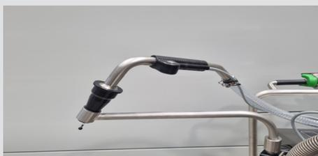
Le bras de dosage réglable en hauteur est monté à droite du chariot **MilchMobil NEXT**. Il sert à l'utilisateur pour fixer le pistolet de dosage en hauteur et à orienter celui-ci. Il est ainsi possible de longer en tout confort
