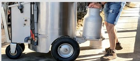
Le porte-bidons accueille jusqu'à deux bidons de lait ou seaux à tétine, ce qui permet de les transporter facilement. Il est possible de relever simplement le porte-bidons, lorsqu'il n'est pas utilisé.
