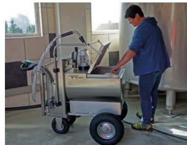
Liegender Tank mit Wasserbad
