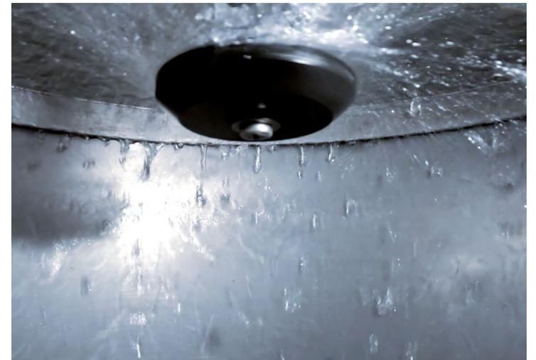
Abb. 6: Automatische Reinigung MilkCollector/SmartTank.
