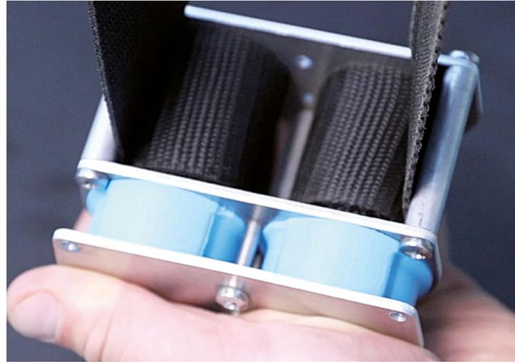
Abb. 2: Spiralfeder für Bandvorrat.
