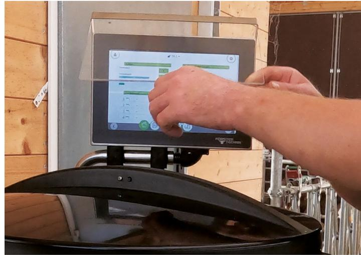
Abb. 2: Transparente Klappe gegen Verschmutzung.
