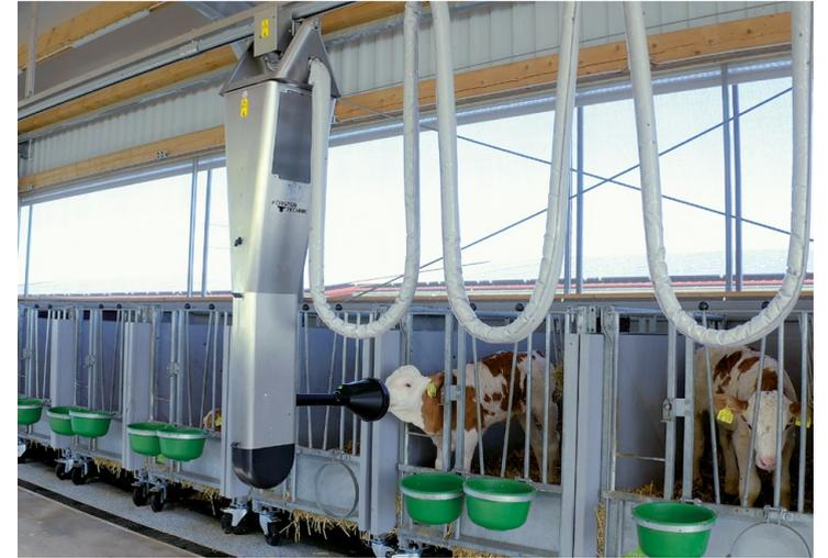
Abb. 3: CalfRail. 50 Kälber bis zu 8 Mal am Tag füttern.
